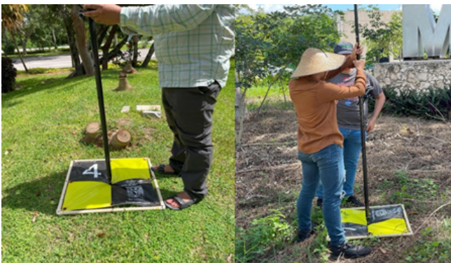
Figura 7. Ejemplo de medición de la posición de los puntos de control con la estación Rover del GPS diferencial.
