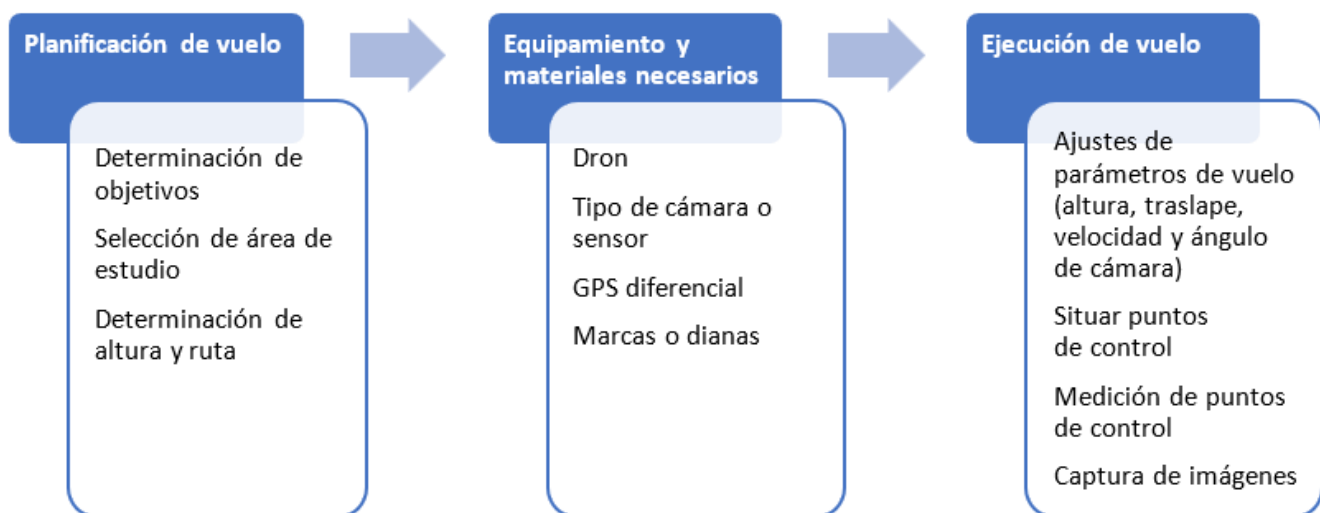
Figura 5. Flujo de trabajo para la ejecución de un vuelo fotogramétrico.
