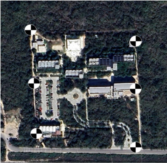
Figura 6. Ejemplo de colocación de los puntos de control, distribuidos dentro del área de estudio.
