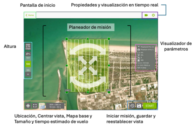
Figura 8. Pantalla de planificación del vuelo en la aplicación Pix4Dcapture.
